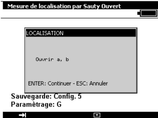
Cette méthode fonctionne sur le même principe que la mesure de Sauty bouclé mais avec A et B ouverts.
