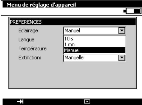
Une autre façon plus rapide pour sélectionner les éléments d'une liste déroulant est possible. Elle consiste à utiliser les touches de navigation **Haut**  $\Delta$  / **Bas**  $\nabla$  pour sélectionner l'élément suivant/précédent dans la liste sans afficher le contenu de la liste.
