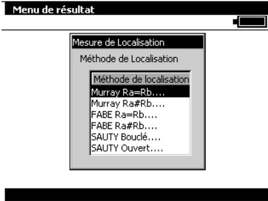
Les touches de navigation **Haut**  $\Delta$  / **Bas**  $\nabla$  permettent de sélectionner la méthode à utiliser.
