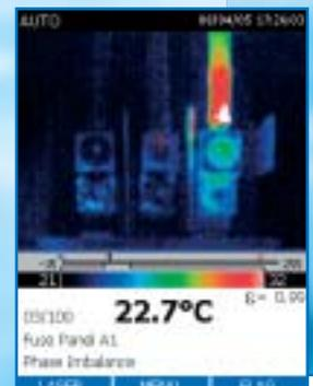
*Une différence de température entre les phases indique une charge déséquilibrée.*
