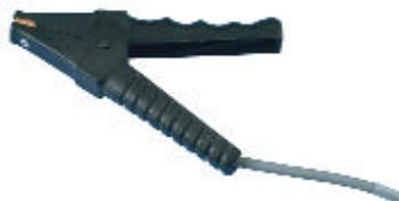
Pince KELVIN grand modèle : l'ouverture maximum de la pince est de 3 cm et elle supporte en permanence un courant de 10 A (livrée avec cordon de 3 m équipé de fiches banane de sécurité).
