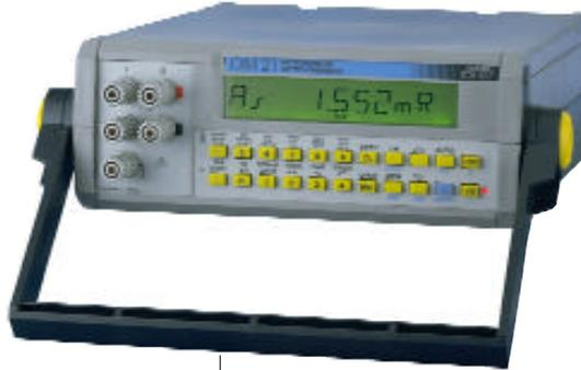
Le microhmmètre OM 21 est destiné à mesurer en 4 fils des résistances à partir de très faibles valeurs ( $0,1 \mu$  de résolution) jusqu'à 200 k avec une excellente précision.
