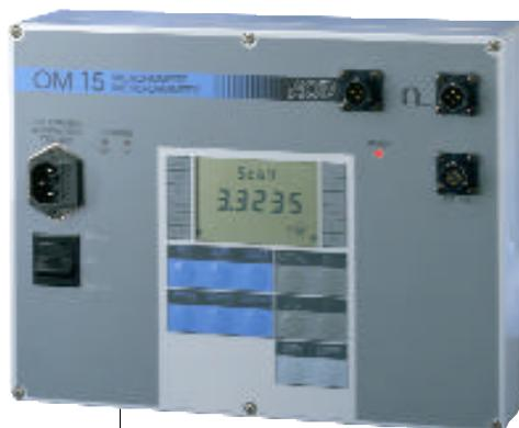
L'OM 15 est un microhmmètre destiné à mesurer en 4 fils des basses valeurs de résistance, en particulier pour vérifier les métallisations et les bonnes continuités de masse. Sa capacité de mesure va de 0,1  $\mu$  (résolution) à 500  $\Omega$  en 6 gammes.
