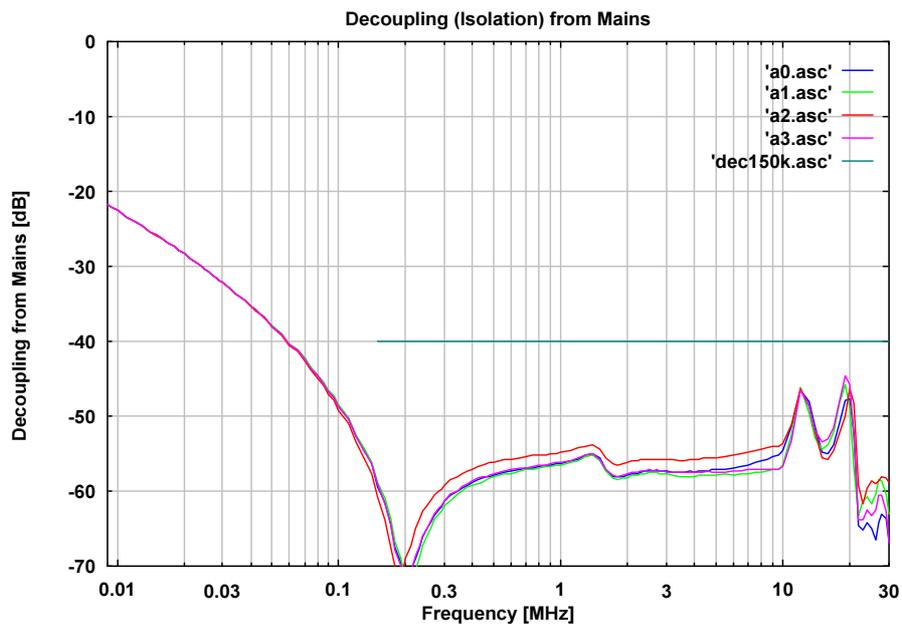
**Abb. 7: Entkopplung vom Speisernetz, BNC mit 50  $\Omega$  Abschluss**
