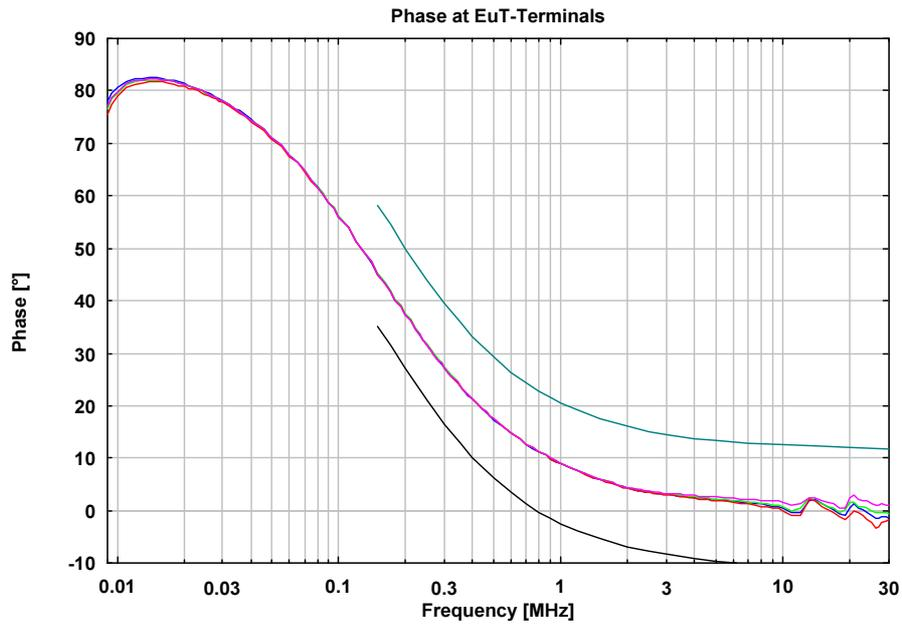
**Abb. 6 Phase an den Prüflingsklemmen, BNC mit 50  $\Omega$  Abschluss**
