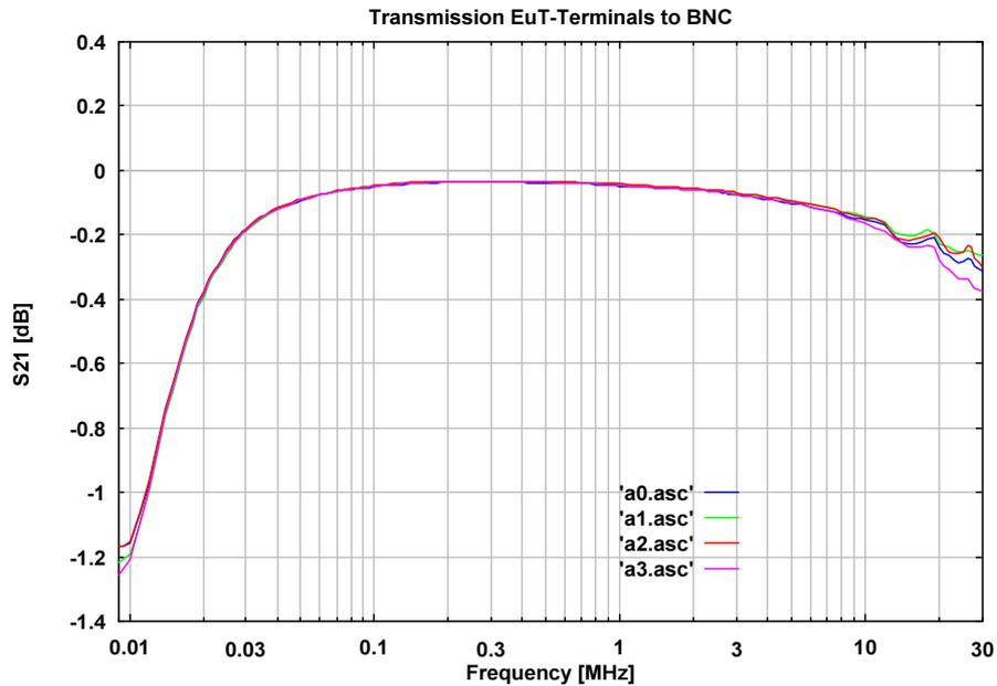
**Abb. 4: Transmission Prüflingsklemmen - BNC**
