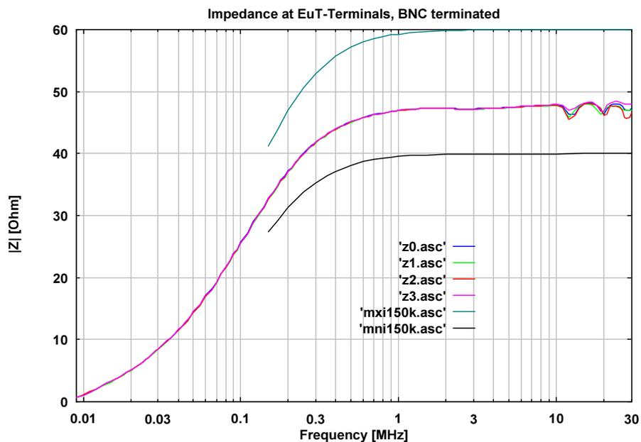
**Abb. 5: Impedanz an den Prüflingsklemmen), BNC mit 50  $\Omega$  Abschluss**
