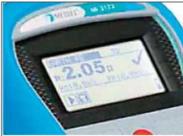
Des tests rapides et précis avec la possibilité de programmer des limites: le PASS / FAIL visuel vous permet un diagnostic instantané.
