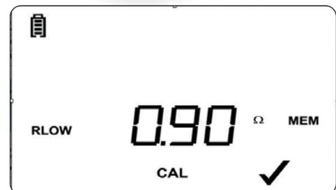
La mesure de continuité sous 200mA, avec inversion de polarité automatique.
