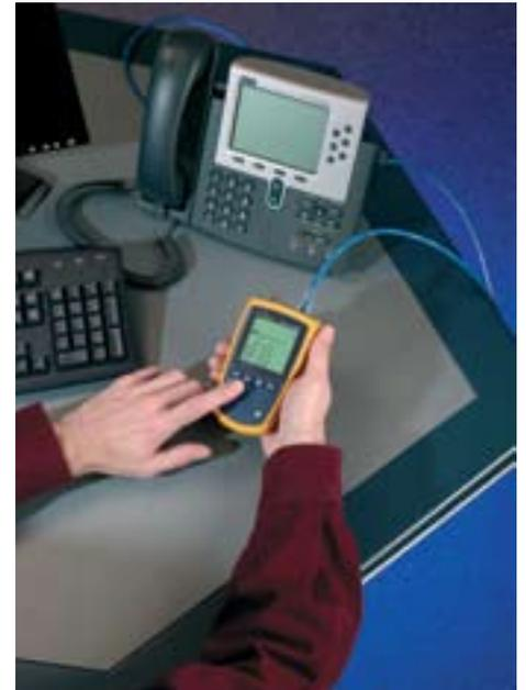
IntelliTone pour localiser avec précision pratiquement tous les câbles ou paires, quel que soit l'environnement de travail. Utilisez le mode numérique pour localiser un câblage réseau de haute qualité (Cat. 5e/6/6a) regroupé en faisceaux, ou au niveau des commutateurs, panneaux de brassage ou prises murales. Vous pouvez également utiliser le mode analogique sur un câblage de qualité téléphonique (Cat. 3 et inférieur) mais aussi coaxial, sécurité/alarme et haut-parleurs.
