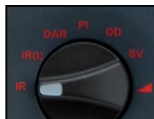
Bouton rotatif de sélection clair et précis. Comprends : RI, IR(t), DAR, IP, DD; Ecart à la loi d'Ohm (SV) et Test de Rampe
