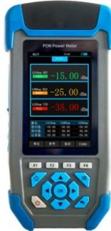
Testeur PON en capacité de tester les signaux voix, data et vidéo en simultané avec analyse. Chaque longueur d'onde est mesurée séparément.
