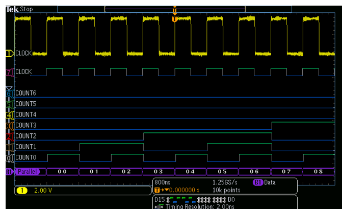
La Série MDO3000 avec l'option MDO3MSO propose 16 voies numériques intégrées qui permettent d'afficher et d'analyser des signaux analogiques et numériques corrélés dans le temps.
