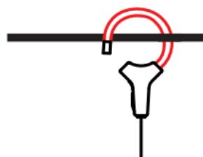
Messschleife wieder schließen. Für optimale Messergebnisse muss der Leiter mittig in der Messschleife ausgerichtet sein, die Messschleife selbst muss so kreisförmig wie möglich gelegt werden.
