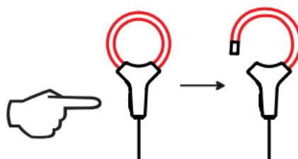
Ábralo, y luego colóquelo alrededor del conductor atravesado por la corriente a medir (un solo conductor en el sensor).
