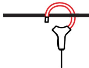
Cierre el toroidal. Para mejorar la calidad de la medida, conviene centrar el conductor en el toroidal y dar a éste una forma la más circular posible.
