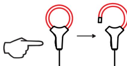
Umschließen Sie nun die Messschleife rund um den Leiter, der den Messstrom führt (es darf nur ein Leiter umschlossen werden).
