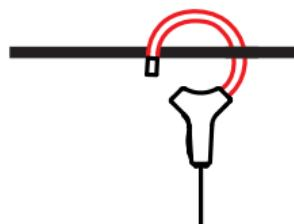
Richiudete il toro. Onde ottimizzare la qualità della misura, occorre centrare il conduttore nel captore e conferire a quest'ultimo la forma più circolare possibile.
