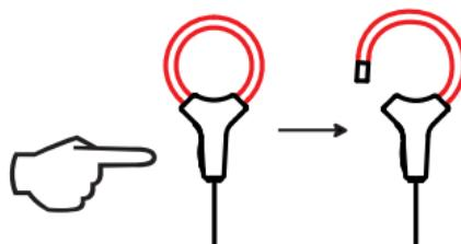
Ouvrez-le, puis placez-le autour du conducteur parcouru par le courant à mesurer (un seul conducteur dans le capteur).
