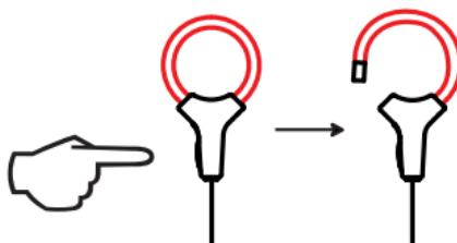
Apritelo, poi posizionatelo intorno al conduttore percorso dalla corrente da misurare (un solo conduttore nel sensore).
