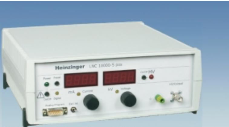
→ Die kompakten **Hochspannungs-Labornetzgeräte** der Heinzinger LNC-Serie liefern als **primärgetaktete HV-Netzteile** eine präzise DC-Spannung, typabhängig bis zu 30.000 Volt bei Leistungen bis 60 Watt. Eine ausgereifte Technologie ermöglicht kompakte Abmessungen in Verbindung mit hoher Regelgenauigkeit und geringer Restwelligkeit. Die anwenderfreundlichen Geräte sind in verschiedenen Spannungs- und Strombereichen verfügbar und lassen sich jeweils bis Nennspannung und Nennstrom regeln.
