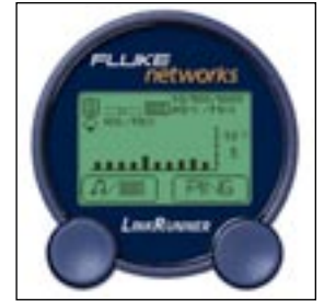
Consultez les informations sur les périphériques, le débit réel de la liaison et les taux d'utilisation.
