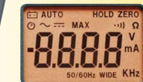
Ecran LCD à afficheur 10 000 points, muni d'un rétro-éclairage.
