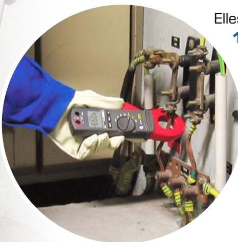
Elles disposent d'un **afficheur 10 000 points rétro-éclairé**, d'une mémorisation d'affichage, des fonctions **mesure de la valeur maxi.** et **mesure différentielle** (Delta). Pour garantir une bonne autonomie, chacune dispose de **l'extinction automatique**, en cas de non-utilisation prolongée de l'appareil.
