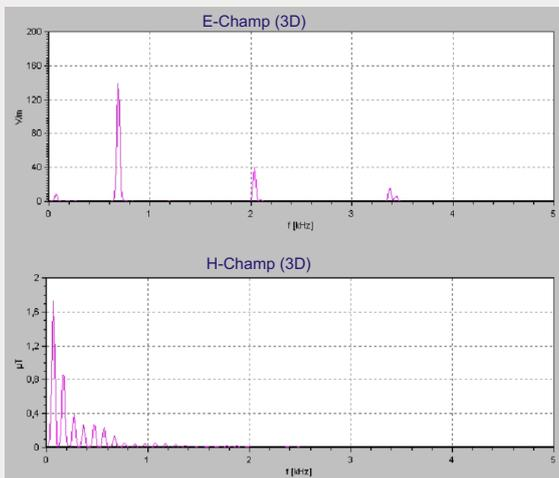
Les 6 canaux FFT option ESM-100 affiche la gamme 3D électrique du champ magnétique d'un moniteur LCD.
