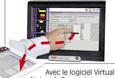
Avec le logiciel Virtual Network Compuing, vous pilotez le DAS 801 avec efficacité et simplicité depuis un ordinateur ou une tablette compatible.
