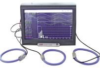
Les mesures sont réalisées en utilisant les entrées tension (directes) de la carte universelle et des pinces accessoires (flexibles ou conventionnelles)
