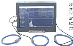
Les mesures sont réalisées en utilisant les entrées tension (directes) de la carte universelle et des pinces accessoires (flexibles ou conventionnelles)
