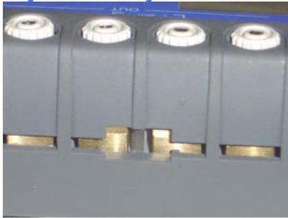
Ce système unique s'utilise en poussant sur le haut de la borne, en insérant les fils jusqu'à un diamètre de 3mm, les fiches thermocouples compensées miniatures, les cosses sur la face avant, puis en relâchant la pression. Les fils sont serrés entre 2 plaques de laiton qui assurent un excellent gradient thermique, ce qui procure une très bonne compensation de soudure froide lors de l'utilisation de thermocouples.
