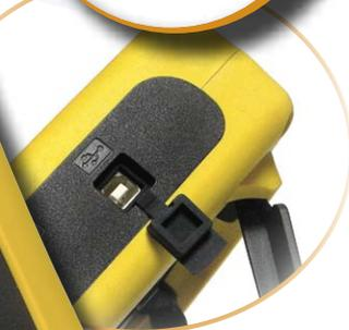
Liaison avec le PC via une connexion USB
