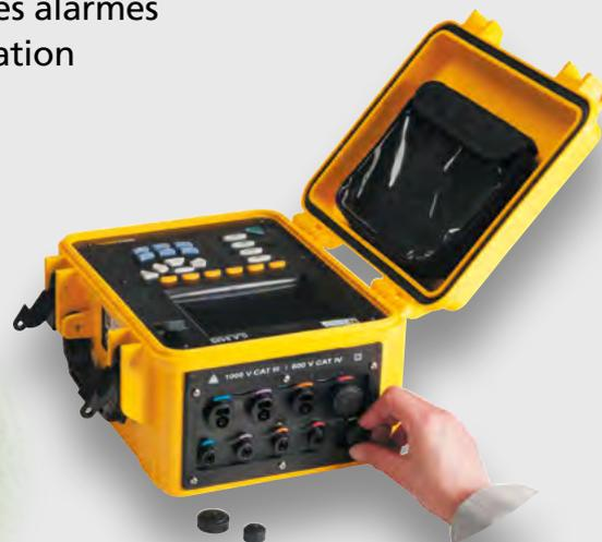
Des bouchons spécifiques ont été développés afin de garantir une étanchéité maximale à l'analyseur C.A 8435.
