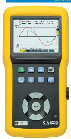
Le **C.A 8230** est destiné aux artisans et installateurs du bâtiment et des services de maintenance. La multiplicité des mesures qu'il propose le destine également à l'enseignement technique et technologique.
