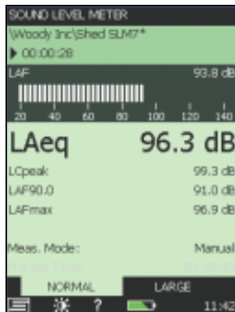
Fig. 3 Exemple d'affichage associé à l'utilisation du module de mesures sonométriques. Les différents paramètres mesurés peuvent être affichés à tout moment
