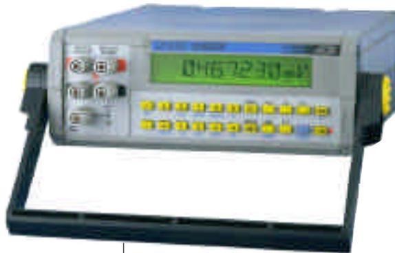
Le SN 8310 est une source étalon. Il fournit des tensions de 100nV- à 110 V- et des courants de 1nA- à 110 mA- avec des précisions de 0,002 % (20 ppm).
