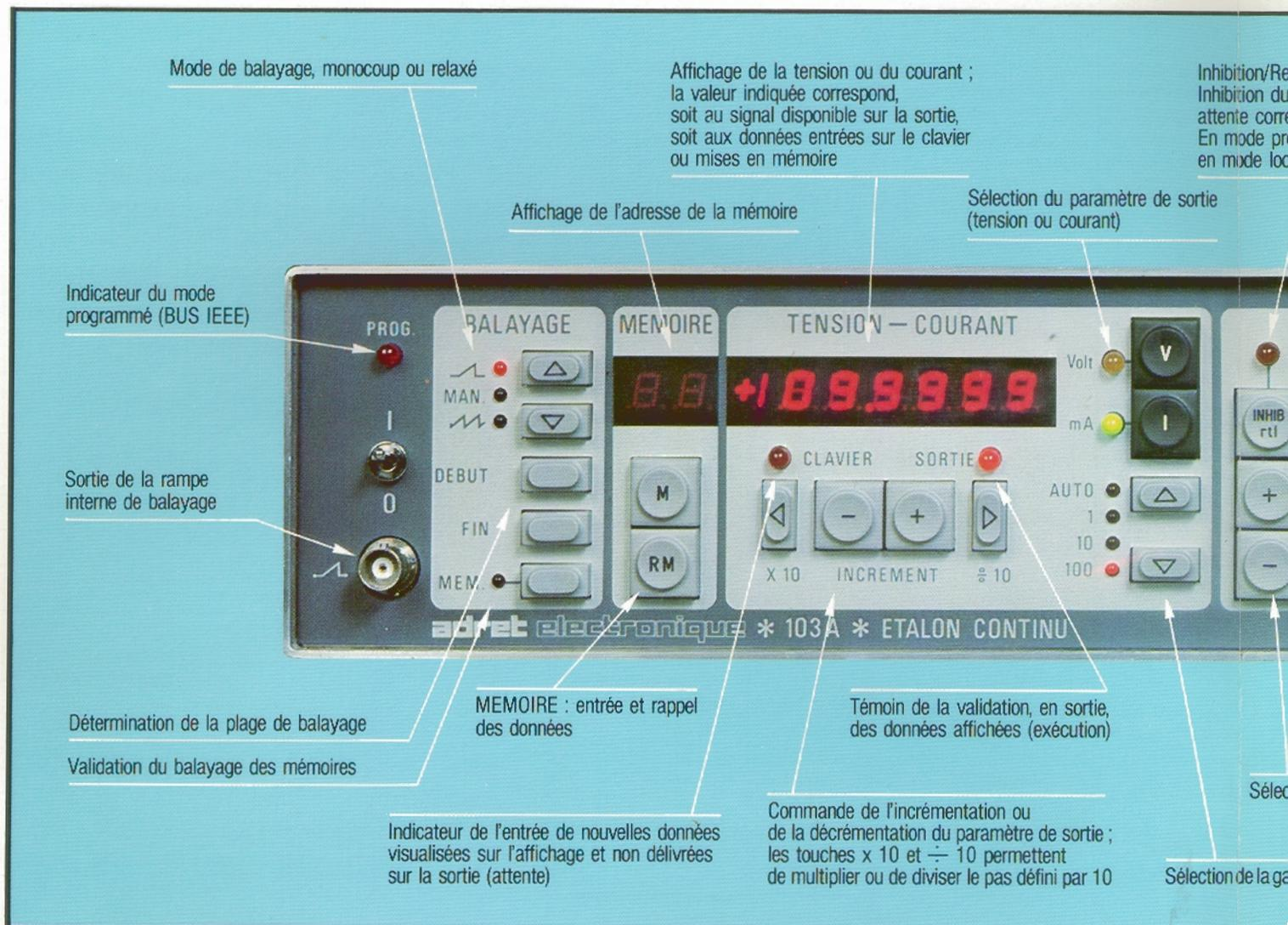
La face avant de l'étalon 103, particulièrement fonctionnelle, est composée de six blocs : BALAYAGE, MEMOIRE, TENSION-COURANT, ENTREE DONNEES, SORTIE et LIMITE.
