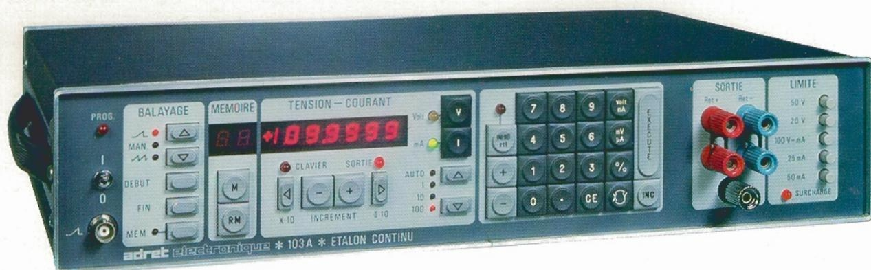
L'étalon de tension et courant type 103 utilise le principe de conversion numérique/analogique à modulation par largeur d'impulsions (brevet ADRETELECTRONIQUE) et allie aux qualités fondamentales de ce procédé, une grande souplesse d'emploi, dûe à la gestion interne par microprocesseur, aussi bien en mode local que programmé.
