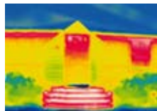
Bâtiment : déperdition énergétique
